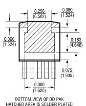
HATCHED AREA IS SOLDER PLATED COPPER HEAT SINK
