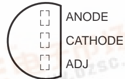
LM336-2.5, LM336B-2.5 . . . LP PACKAGE (TOP VIEW)
