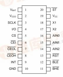
20-Pin TSSOP 20-Pin SOIC
