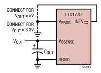
Figure 8a. Fixed 3.3V or 5V V<sub>OUT</sub>
