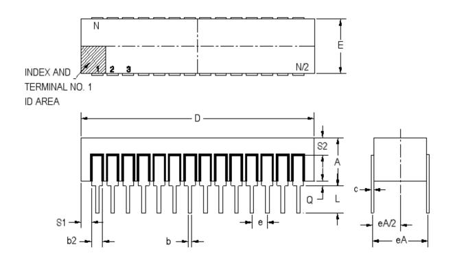
28-PIN RAD-PAK® DUAL IN LINE PACKAGE
