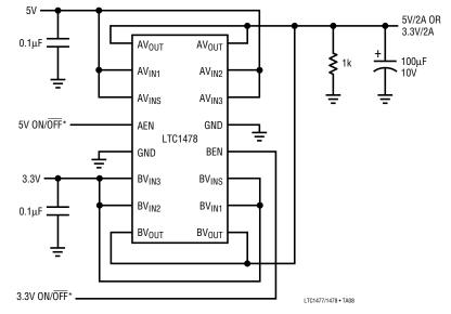
\*ALLOW AT LEAST 100ms BETWEEN 5V AND 3.3V SWITCHING FOR DISCHARGE OF 100µF OUTPUT CAPACITOR
