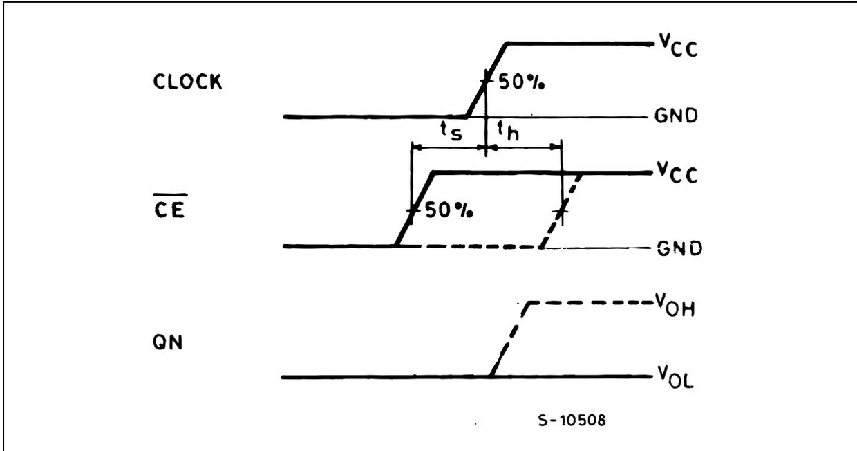
WAVEFORM 3 : MINIMUM PULSE WIDTH, PROPAGATION DELAY (f=1MHz; 50% duty cycle)
