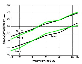
FIGURE 12. DRIVER PROPAGATION DELAY vs **TEMPERATURE (ISL81487)**
