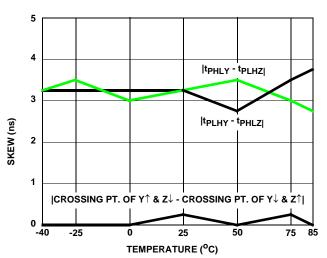
FIGURE 13. DRIVER SKEW vs TEMPERATURE (ISL81487)
