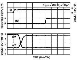
FIGURE 16. DRIVER AND RECEIVER WAVEFORMS, LOW TO HIGH (ISL81487)
