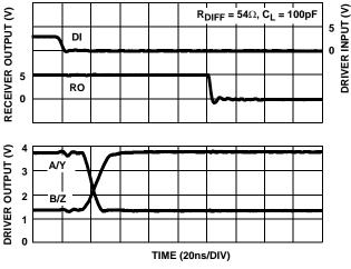
FIGURE 17. DRIVER AND RECEIVER WAVEFORMS, HIGH TO LOW (ISL81487)
