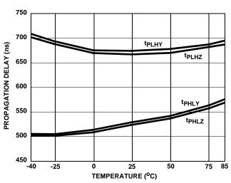
FIGURE 10. DRIVER PROPAGATION DELAY vs **TEMPERATURE (ISL8487, ISL81483)**
