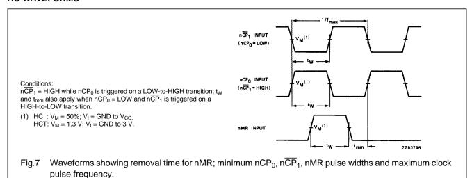
(1) HC: V<sub>M</sub> = 50%; V<sub>I</sub> = GND to V<sub>CC</sub>.
