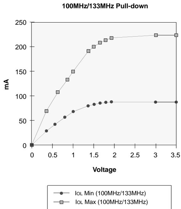
V<sub>DD</sub> Clamp @ CLK, CKE, CS, DQM & DQ
