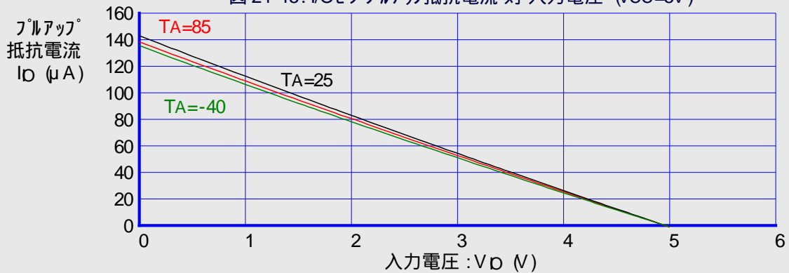
図 24-15. I/Oヒンプルアップ抵抗電流 対 入力電圧 (VCC=5V)
