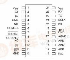
DS1616 24-Pin DIP (600 mil) DS1616S 24-Pin SOIC (300 mil)
