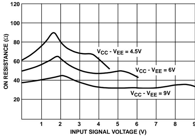
FIGURE 11. TYPICAL ON RESISTANCE vs INPUT SIGNAL VOLTAGE
