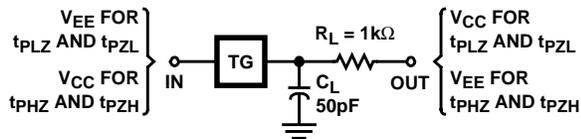
FIGURE 9. SWITCH ON/OFF PROPAGATION DELAY TEST CIRCUIT
