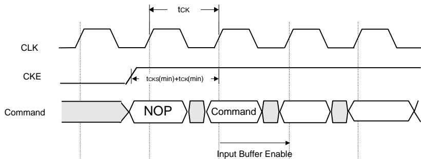
B)  $t_{CK} \geq t_{CKS(min)} + t_{CK(min)}$
