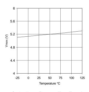
Graph 14. V<sub>FMIN</sub> vs Temperature (IR2159/IR21591)
