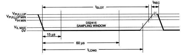
60  $\mu s \le t_{LOW0} < t_{SLOT} < 120 \ \mu s$ 1  $\mu s \le t_{REC} < \infty$
