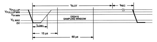
60  $\mu s \le t_{SLOT} < 120 \ \mu s$ 1  $\mu s \le t_{LOW1} < 15 \ \mu s$ 1  $\mu s \le t_{REC} < \infty$
