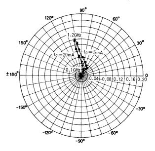
S22e : V<sub>CE</sub>= 10V f=100MHz, 200 to 1200MHz(200MHz step)
