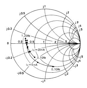
S21e: V<sub>CE</sub>=10V f=100MHz, 200 to1200MHz(200MHz step)
