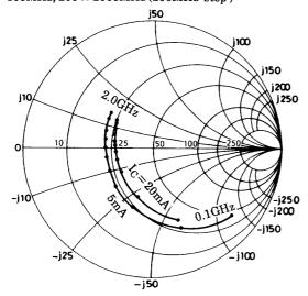
$\begin{array}{l} S21e:V_{CE}\!=\!5V\\ f\!=\!100MHz, 200\,\mathrm{to}\,2000MHz\,(200MHz\ step\,) \end{array}$
