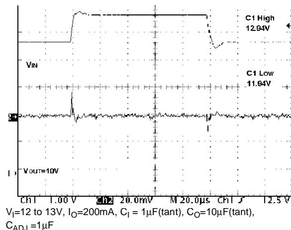
**Figure 20 : Load Transient**
