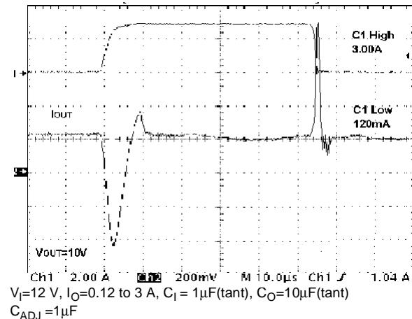
**Figure 21 : Load Transient**
