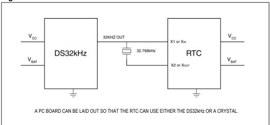
Figure 6. DS32kHz and RTC Connections
