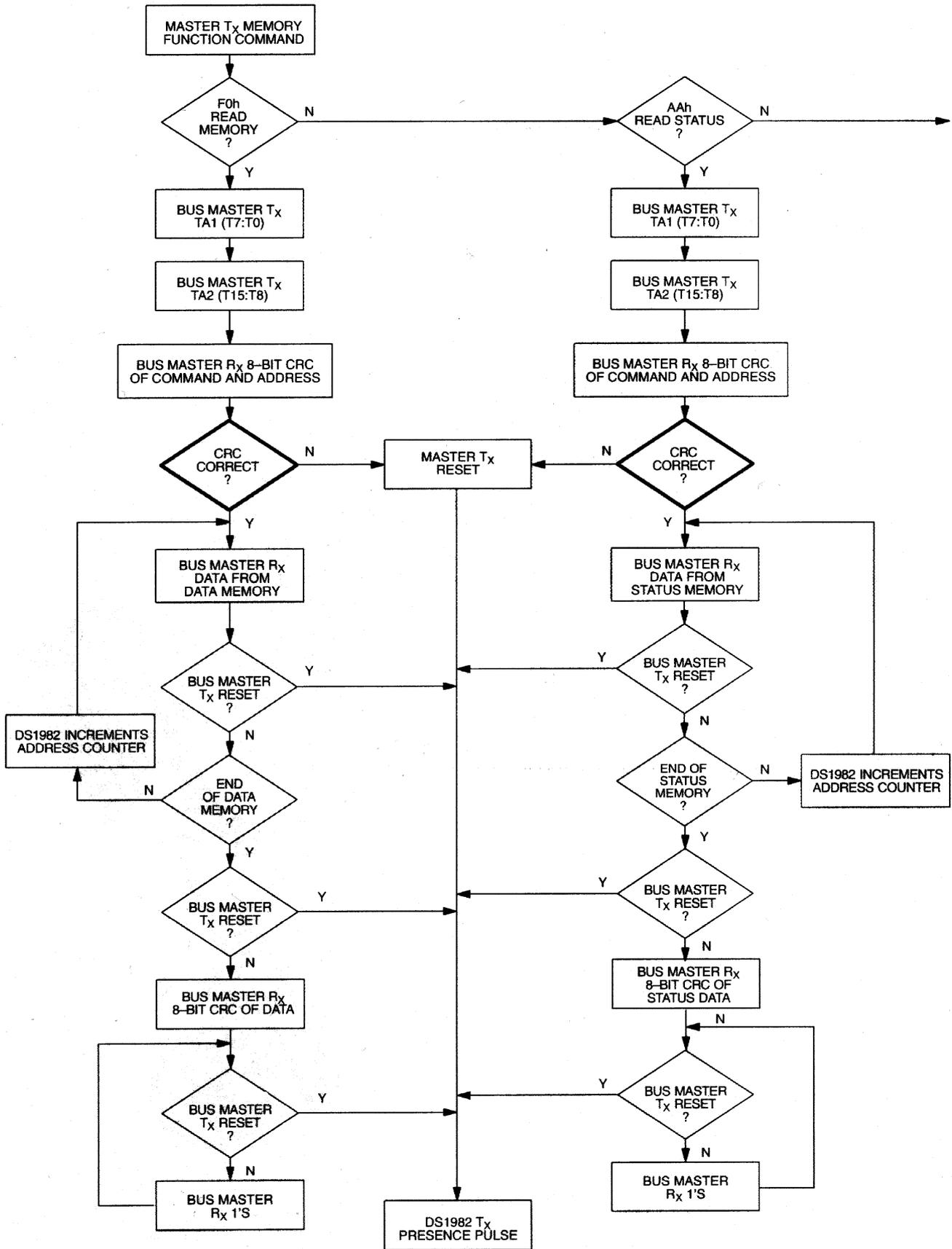
存储器功能命令流程图 图 6 (续)
