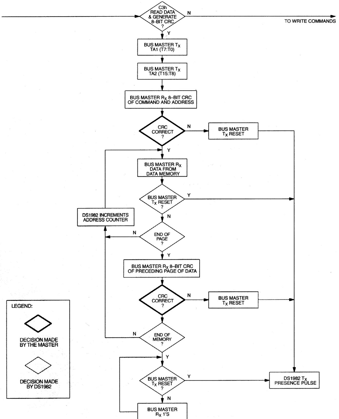
存储器功能命令流程图 图6 (续)
