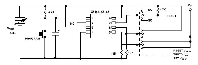
FIGURE 4. SAMPLE V<sub>TRIP</sub> RESET CIRCUIT
