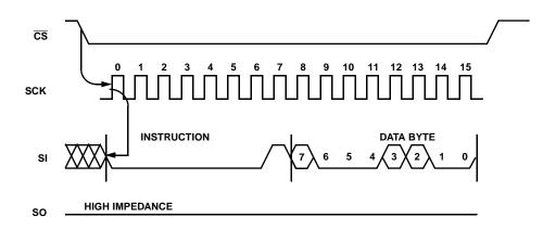
FIGURE 9. STATUS REGISTER WRITE SEQUENCE
