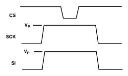
FIGURE 1. SET V<sub>TRIP</sub> VOLTAGE
