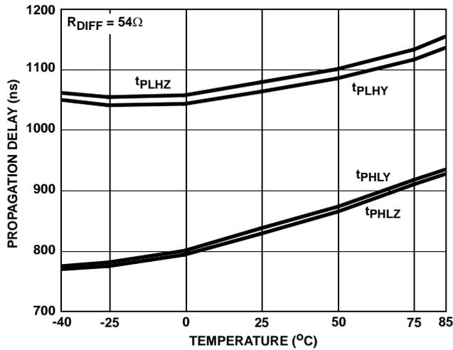
FIGURE 10. DRIVER PROPAGATION DELAY vs TEMPERATURE (ISL83483, ISL83488)
