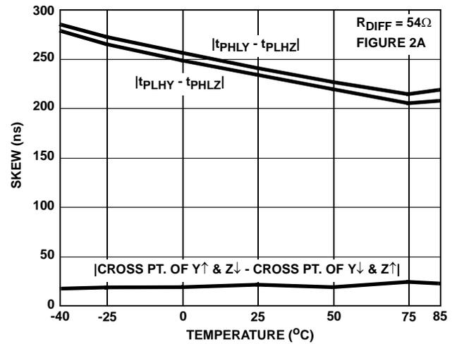
FIGURE 11. DRIVER SKEW vs TEMPERATURE (ISL83483, ISL83488)
