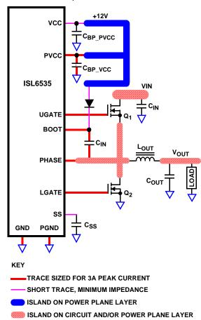
FIGURE 5. PRINTED CIRCUIT BOARD POWER PLANES
