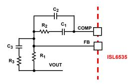
FIGURE 6. COMPENSATION CONFIGURATION FOR THE ISL6535 CIRCUIT
