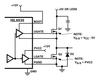
FIGURE 10. UPPER GATE DRIVE - DIRECT V<sub>CC</sub> DRIVE OPTION
