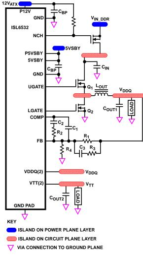
FIGURE 4. PRINTED CIRCUIT BOARD POWER PLANES AND ISLANDS
