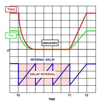
FIGURE 3.  $V_{TT}/V_{\mbox{\scriptsize DDQ}}$  LDO UNDER VOLTAGE PROTECTION RESPONSES
