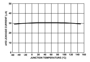
FIGURE 12. HIGH VOLTAGE LEAKAGE CURRENT
