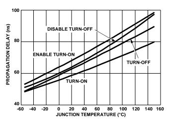
FIGURE 8. PROPAGATION DELAY
