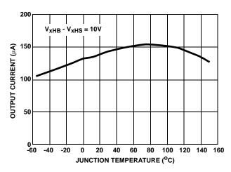
FIGURE 7. CHARGE PUMP OUTPUT CURRENT
