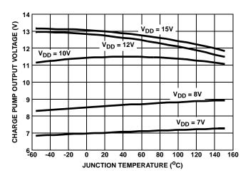
FIGURE 8. CHARGE PUMP OUTPUT VOLTAGE
