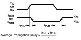
FIGURE 4. PROPAGATION DELAY DEFINITION
