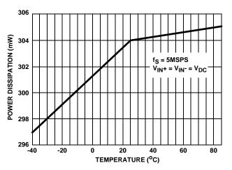
FIGURE 11. POWER DISSIPATION vs TEMPERATURE
