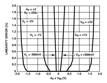
FIGURE 34. LINEARITY NEAR LIMIT VOLTAGE
