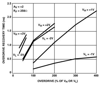
FIGURE 36. OVERDRIVE RECOVERY TIME vs OVERDRIVE
