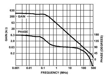
FIGURE 25. OPEN LOOP TRANSIMPEDANCE
