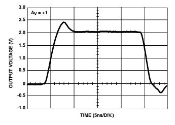
FIGURE 11. LARGE SIGNAL POSITIVE PULSE RESPONSE
