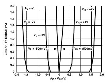
FIGURE 35. LINEARITY NEAR LIMIT VOLTAGE
