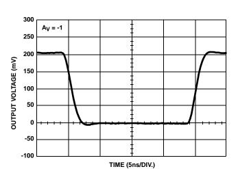
FIGURE 14. SMALL SIGNAL POSITIVE PULSE RESPONSE
