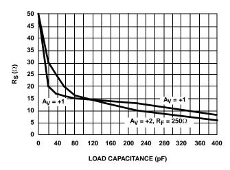
FIGURE 1. RECOMMENDED SERIES RESISTOR vs LOAD CAPACITANCE
