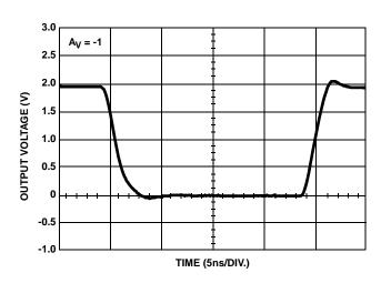
FIGURE 15. LARGE SIGNAL POSITIVE PULSE RESPONSE
