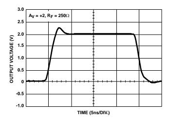
FIGURE 7. LARGE SIGNAL POSITIVE PULSE RESPONSE
