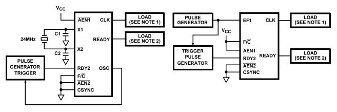
FIGURE 7. TRYLCL, TRYHCH LOAD CIRCUITS
