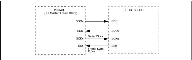
FIGURE 15-5: SPI SLAVE, FRAME MASTER CONNECTION DIAGRAM
