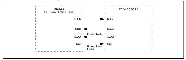
FIGURE 15-6: SPI SLAVE, FRAME SLAVE CONNECTION DIAGRAM
