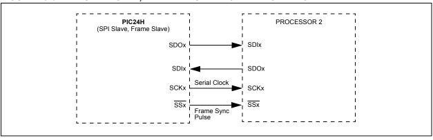
FIGURE 15-4: SPI MASTER, FRAME SLAVE CONNECTION DIAGRAM
