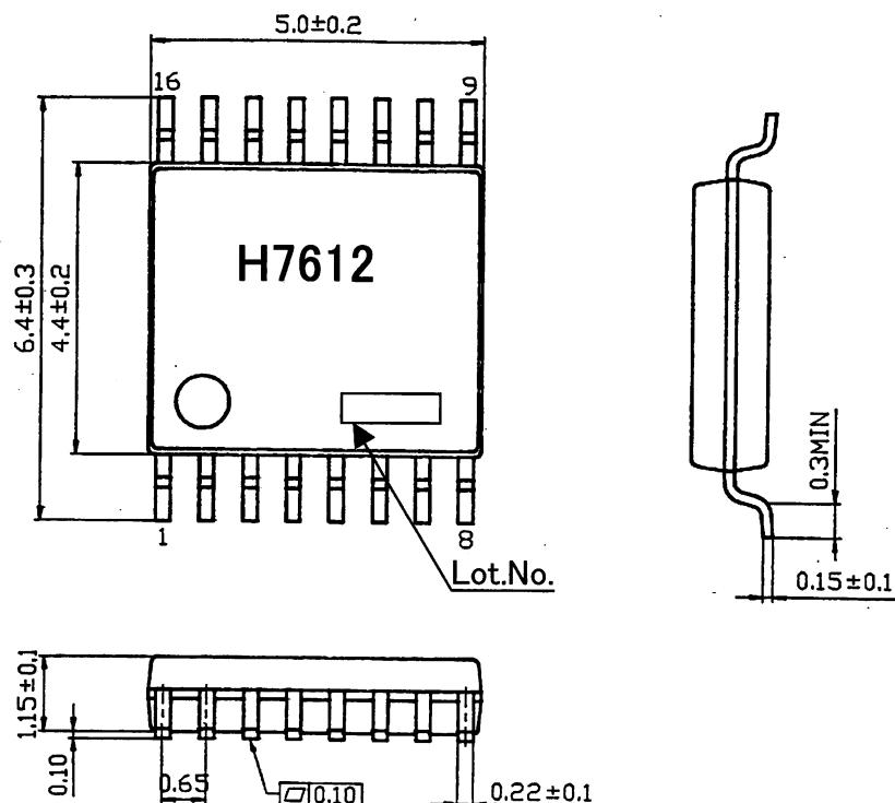
SSOP-B16 (Unit: mm)
