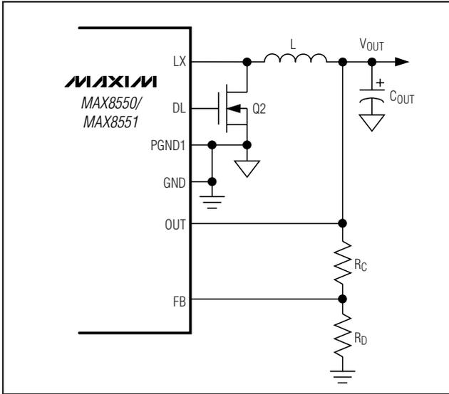
图 6. 利用电阻分压器设定 $V_{OUT}$
