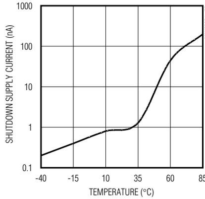
**SHUTDOWN SUPPLY CURRENT vs. TEMPERATURE (MAX5523/MAX5525)**
