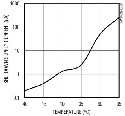
**STANDBY SUPPLY CURRENT vs. TEMPERATURE (MAX5523/MAX5525)**
