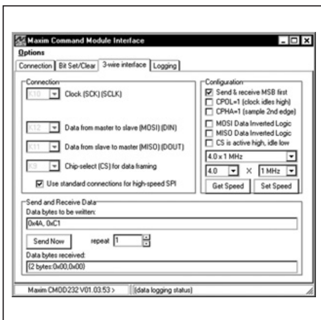
图3. MAX19700 评估板软件 3 线接口诊断界面
