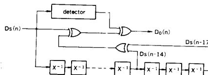
•  $x^{-1}$  : 1 bit delay circuit
