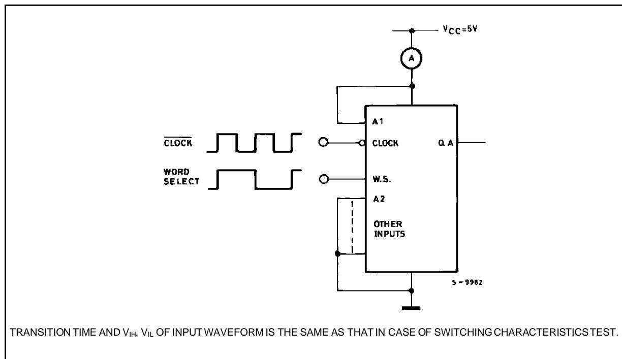
TRANSITION TIME AND  $V_{IH}$ ,  $V_{IL}$  OF INPUT WAVEFORM IS THE SAME AS THAT IN CASE OF SWITCHING CHARACTERISTICS TEST.
