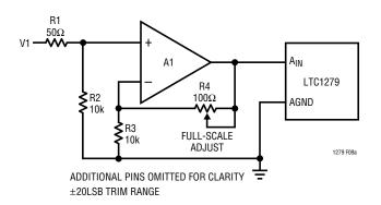
Figure 9a. Full-Scale Adjust Circuit
