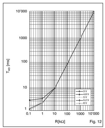
$T_{\text{WD}}$  versus  $V_{\text{OUTPUT}}$  at  $T_{\text{J}} =$  -40  $^{\circ}\text{C}$
