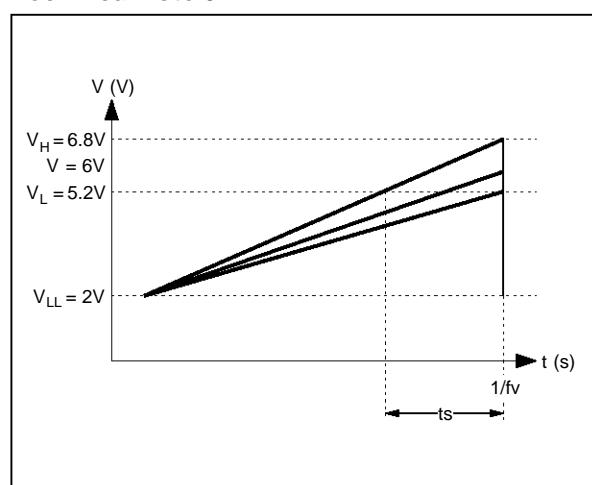
$$\frac{V_H - V_L}{t_s} = \frac{V_H - V_{LL}}{1/f_V}$$
