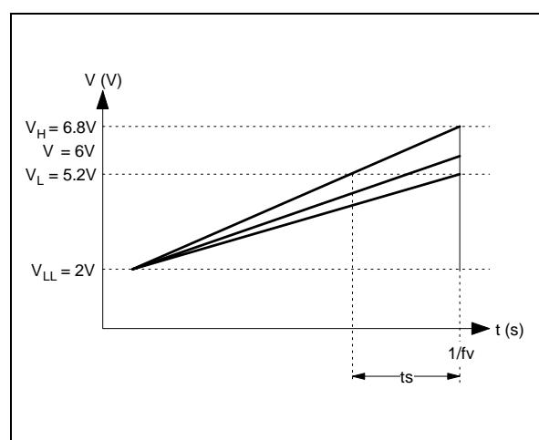
$$\frac{V_H - V_L}{t_s} = \frac{V_H - V_{LL}}{1/f_V}$$
