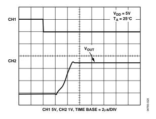
Figure 20. Exiting Power-Down Mode
