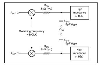
FIGURE 3. Input Impedance of the ADS1201.
