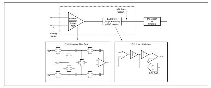
FIGURE 2. Block Diagram of the ADS1201.
