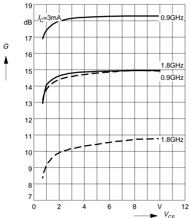
**Power Gain**  $G_{\text{ma}}, G_{\text{ms}} = f(f)$
