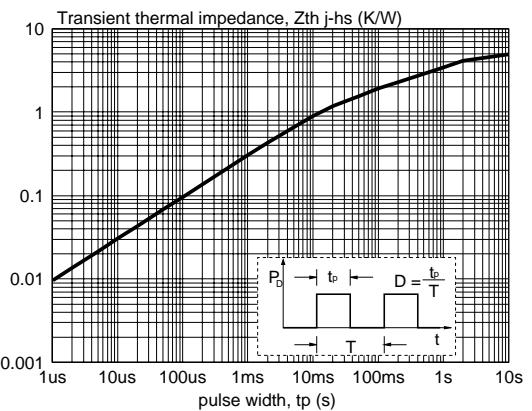
Fig.9. Transient thermal impedance per diode
