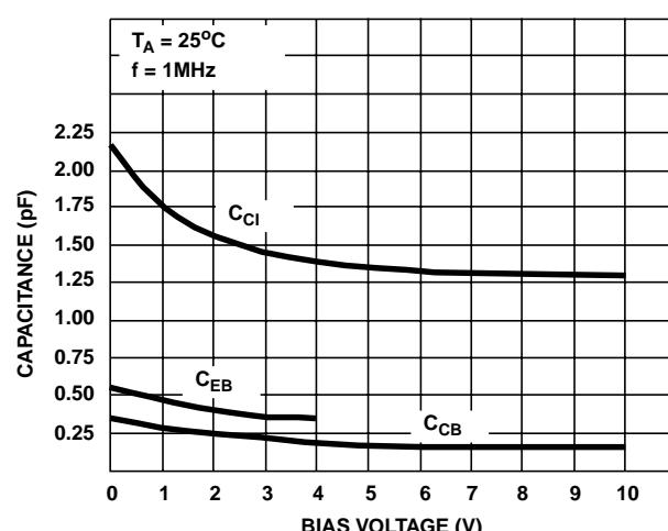
FIGURE 8A. CAPACITANCE vs BIAS VOLTAGE FOR Q<sub>2</sub>
