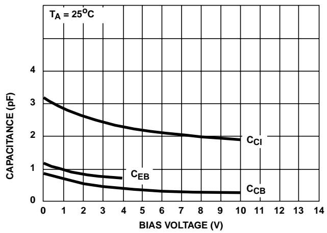
FIGURE 18.  $C_{EB}$ ,  $C_{CC}$ ,  $C_{CI}$  vs BIAS VOLTAGE
