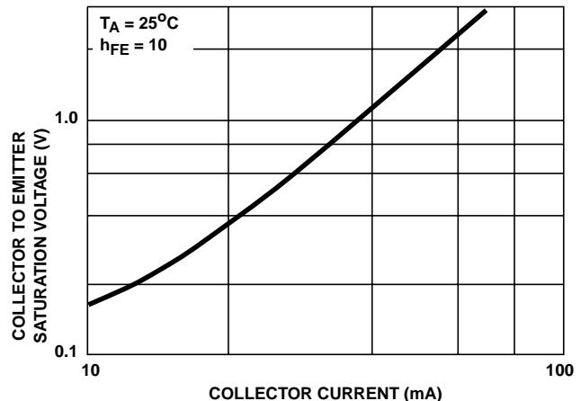
FIGURE 24.  $V_{CE\ SAT}$  vs  $I_C$  FOR ANY TRANSISTOR
