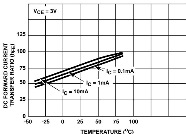
FIGURE 21.  $h_{FE}$  vs TEMPERATURE FOR ANY TRANSISTOR
