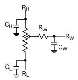
**Potentiometer Equivalent Circuit**
