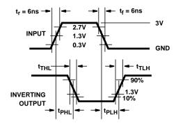
FIGURE 7. HCT TRANSITION TIMES AND PROPAGATION DELAY TIMES, COMBINATION LOGIC
